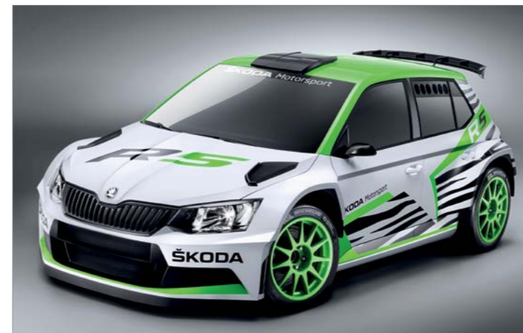
279 KONÍ Škoda Fabia R5 má pohon všech čtyř kol a pohání ji 1,6litrový turbomotor.
